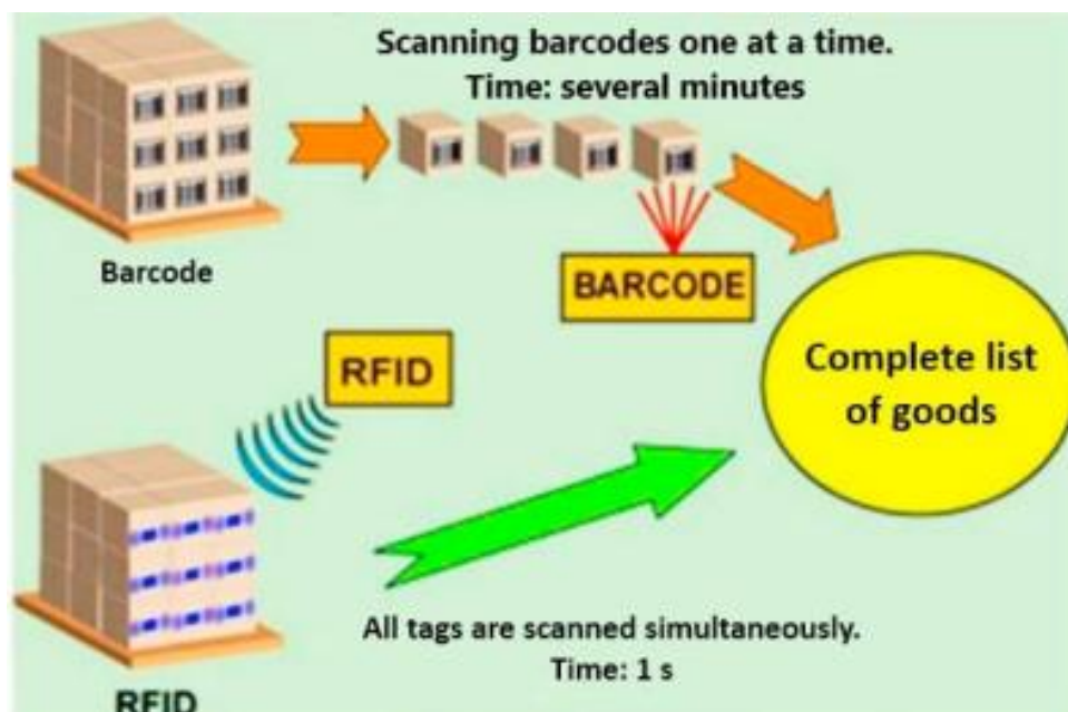
Фигура 3:Предимство на RFID технологията при работата с УТЕ Източник: Попова, Ирина, 2021
